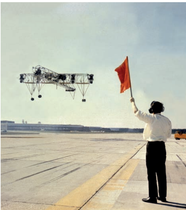
Das Reglerversuchsgestell zur Erprobung des Schweflugs im Dornier Senkrechtstarterprogramm
