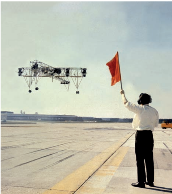
Das Reglerversuchsgestell zur Erprobung des Schwebflugs im Dornier Senkrechtstarterprogramm
